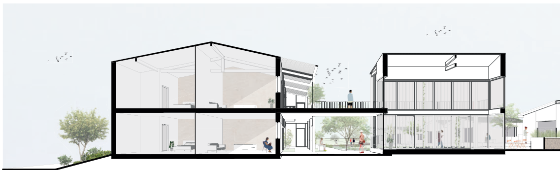
Logements Tz coursives sur jardin
